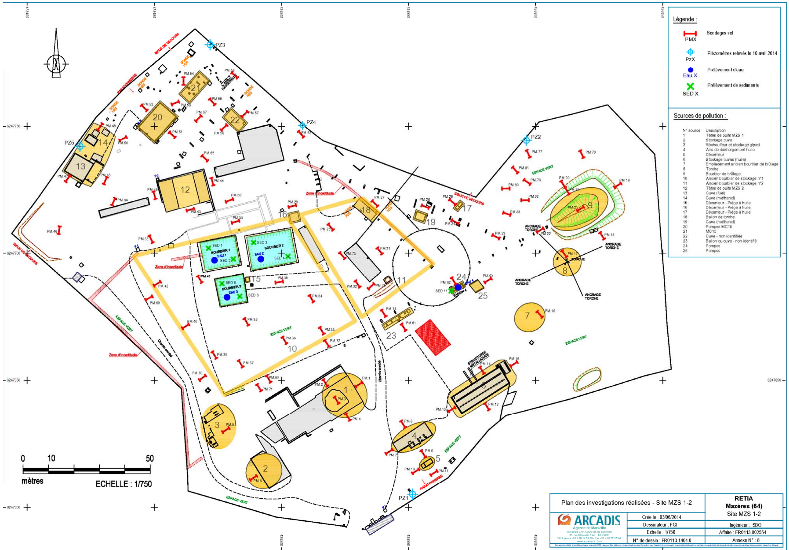
Figure 3 : Implantation des sondages et des points de prélèvements, site MZS1-2/MC15 (extrait du rapport ARCADIS)
